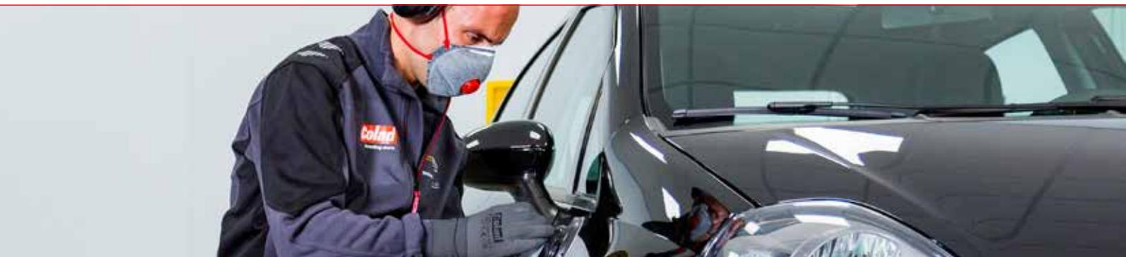
La fibra abrasiva puede ser usada en procesos en seco o en húmedo, a mano o a máquina en matizados de superficies. No ataca a la superficie dejando siempre la forma original de la misma. Tipo A Very Fine (rojo) está recomendado para lijado de plásticos sin pintar, madera y aluminio. Tipo S Ultra Fine (gris) se recomienda para el matizado del aparejo.
